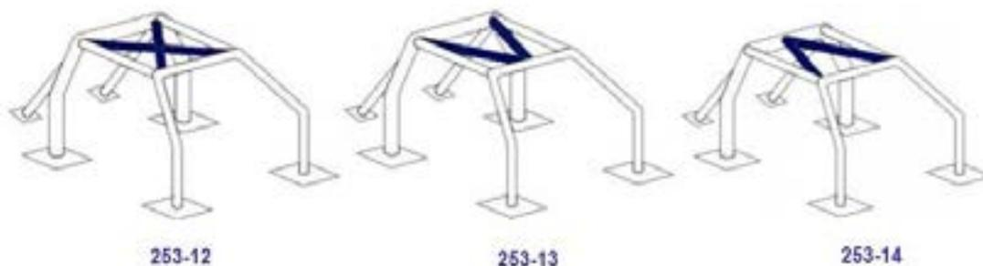
Les extrémités des entretoises doivent se trouver à moins de 100 mm des jonctions entre les arceaux et entretoises de la structure de base (non applicable au sommet du V formé par les renforts des dessins 253-13 et 253-14).
